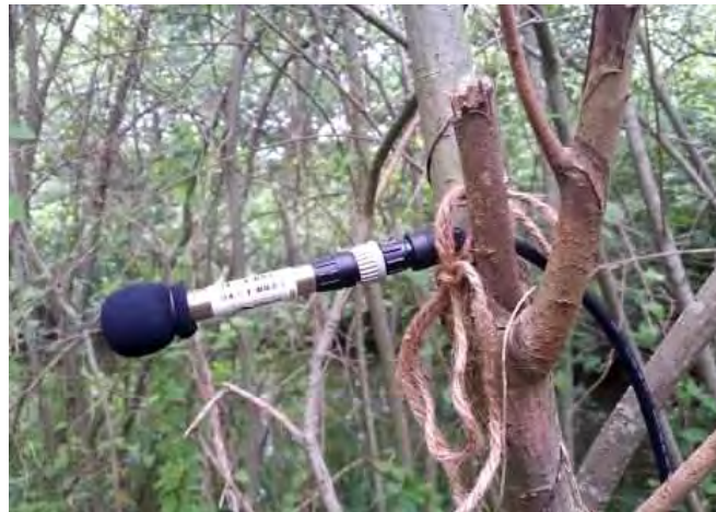
Illustration 3 : Installation du système de détection passif de chiroptères (D, Peterss et SM3 wildlife acoustics)
