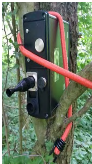
Illustration 3 : Installation du système de détection passif de chiroptères (D, Peterss et SM3 wildlife acoustics)
