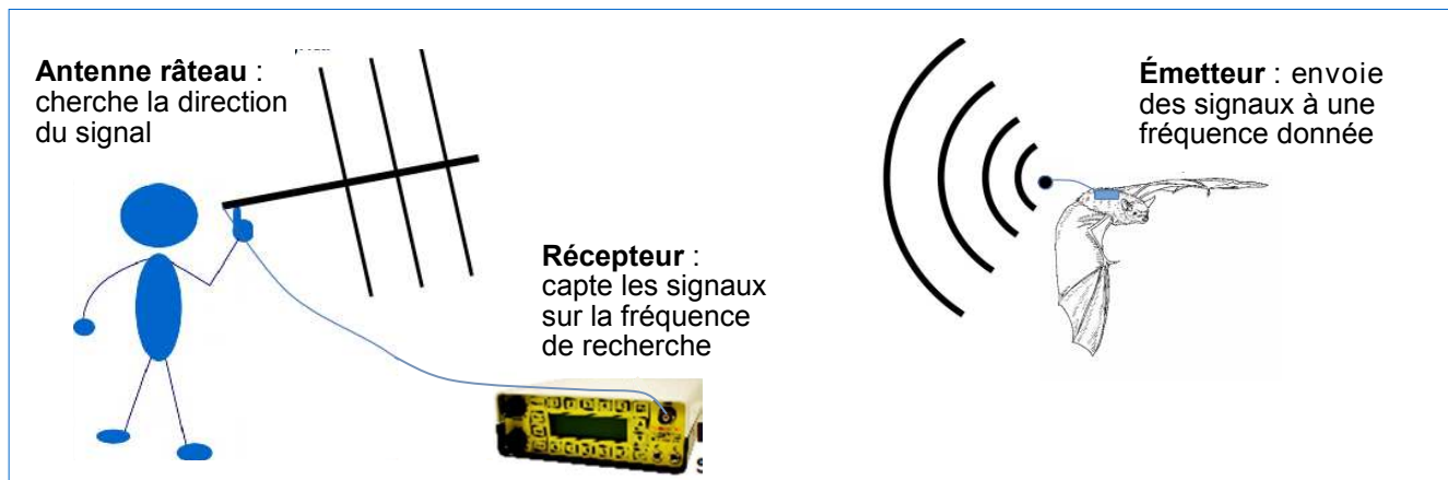
Figure 8 : principe du radiopistage.
