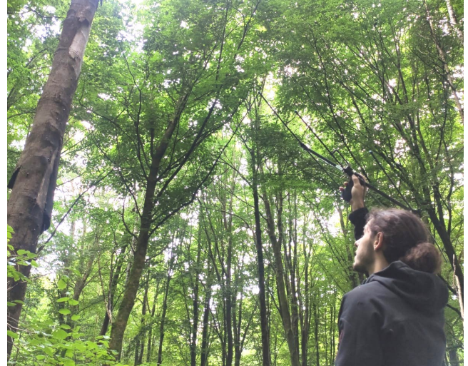
Photo 6 : Une antenne râteau, permettant, reliée à son récepteur, de connaître la direction du signal. © A. PUDEPIÈCE
