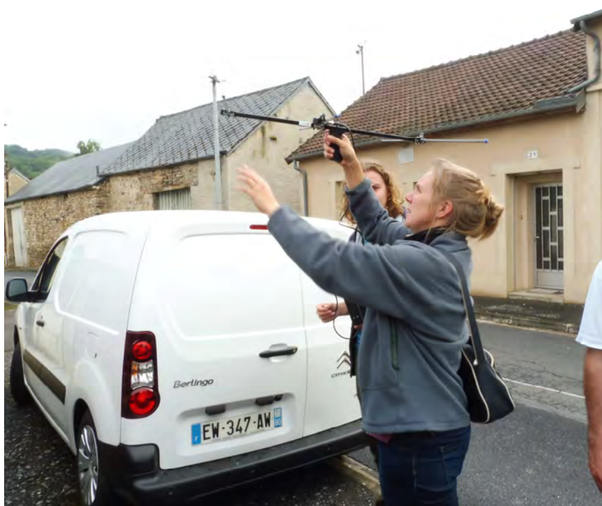
Illustration 7 : Recherche du signal de l'émetteur (fixé sur le dos de la chauve-souris) à l'aide d'une antenne râteau reliée à un récepteur
