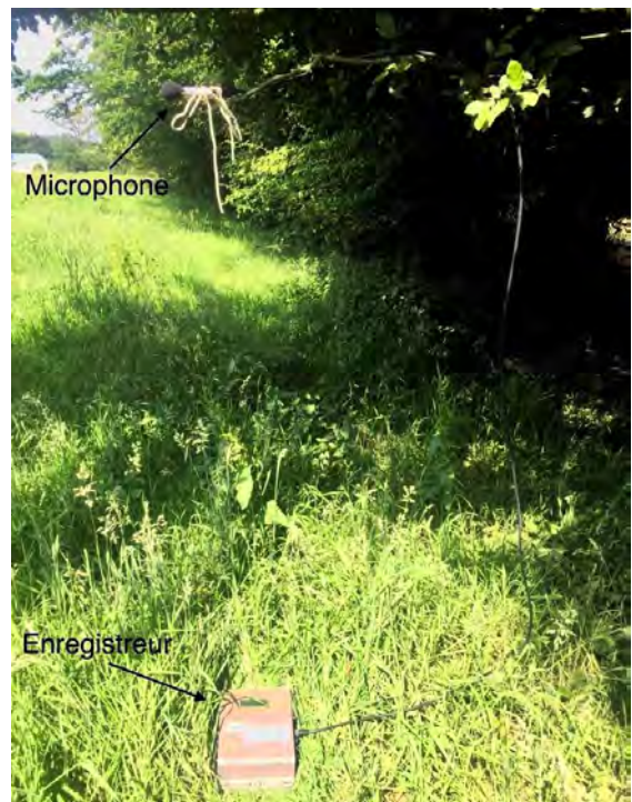
Photo 5 (Photo Aurélien BATAILLE) Enregistreur passif SM3. Le micro est déporté à environ 2 mètres de hauteur.
