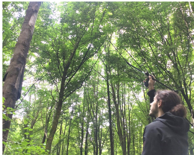
Photo 6 : Une antenne râteau, permettant, reliée à son récepteur, de connaître la direction du signal. © A. PUDEPIÈCE
